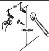
2. Vede as conexões com fita de teflon para evitar vazamentos. (Nota: Não aperte demais para evitar danos).
